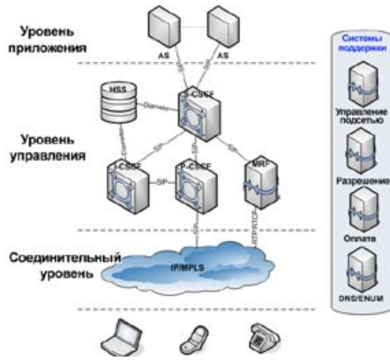
Рис. 8. Многоуровневая архитектура IMS
