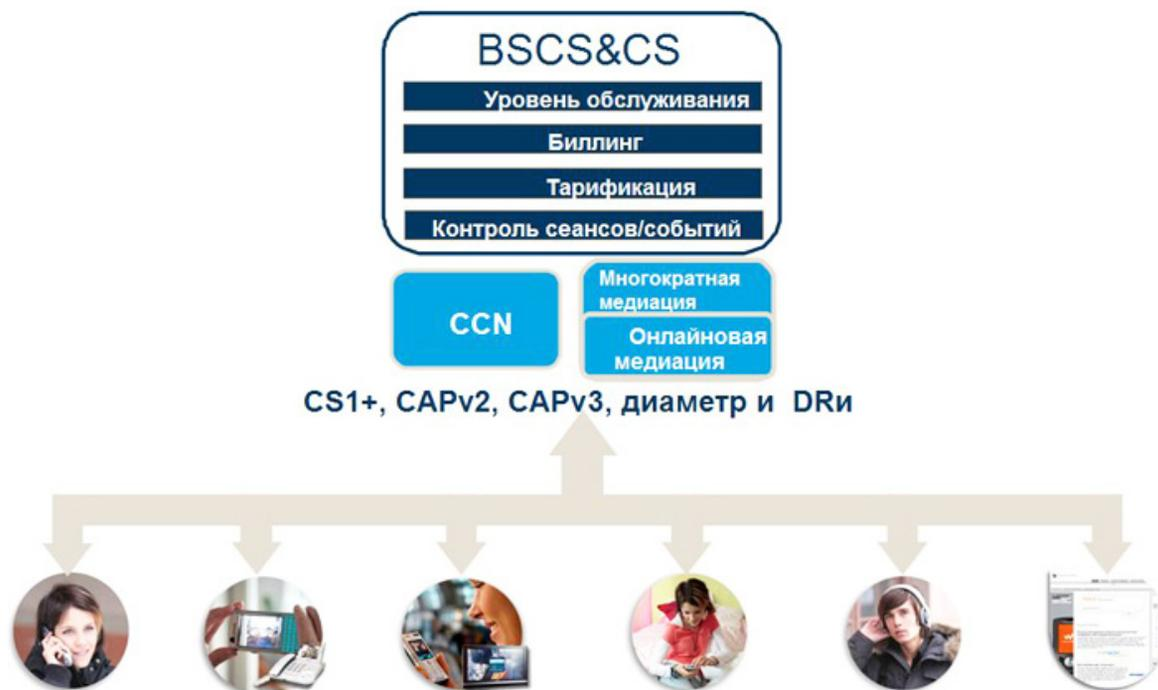
Рис. 8. Поддержка стандартных интерфейсов для тарификации в реальном времени и биллинга с помощью CDR-файлов
