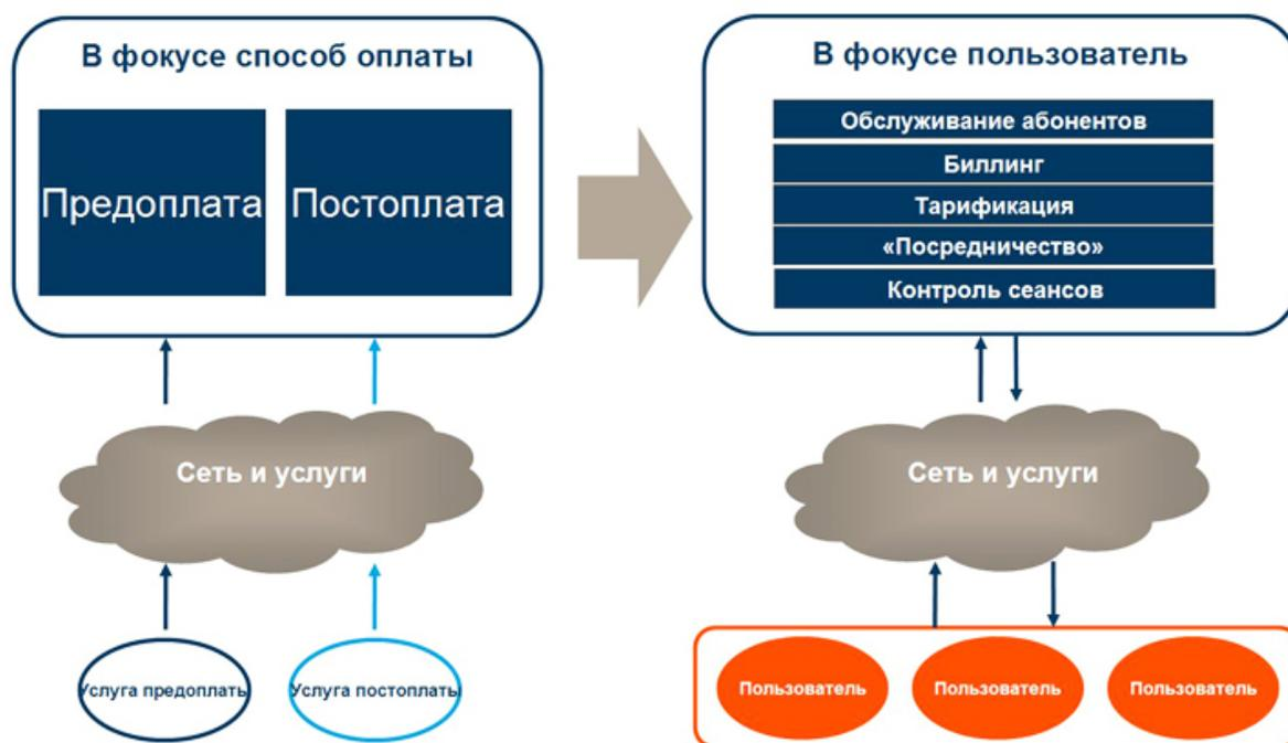
Рис. 2. Переход от вертикальных предоплатных и постоплатных систем к горизонтальной архитектуре системы тарификации и биллинга
