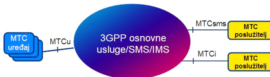
Slika 2-2: 3GPP M2M mrežna arhitektura
