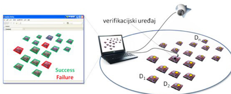
Slika 9: Arhitektura predloženog višekanalnog mehanizma za inicijalnu uspostavu sigurnosnih asocijacija.
