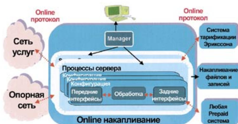
Рис. 10. Схема системы для online накопления тарифных данных
