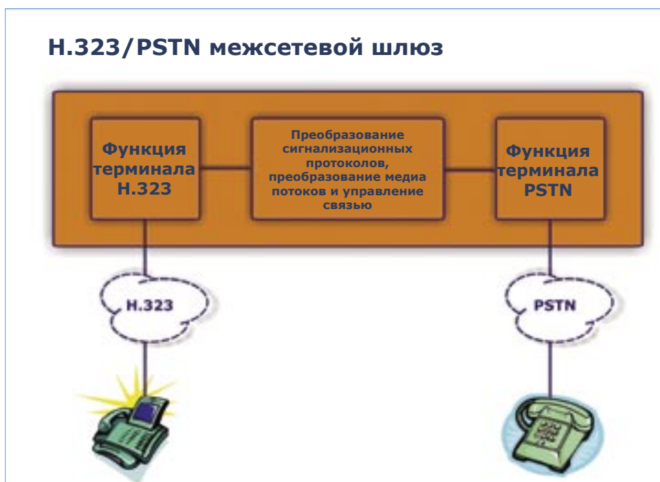
Рис. 4. Функциональное изображение шлюза H.323/PSTN
