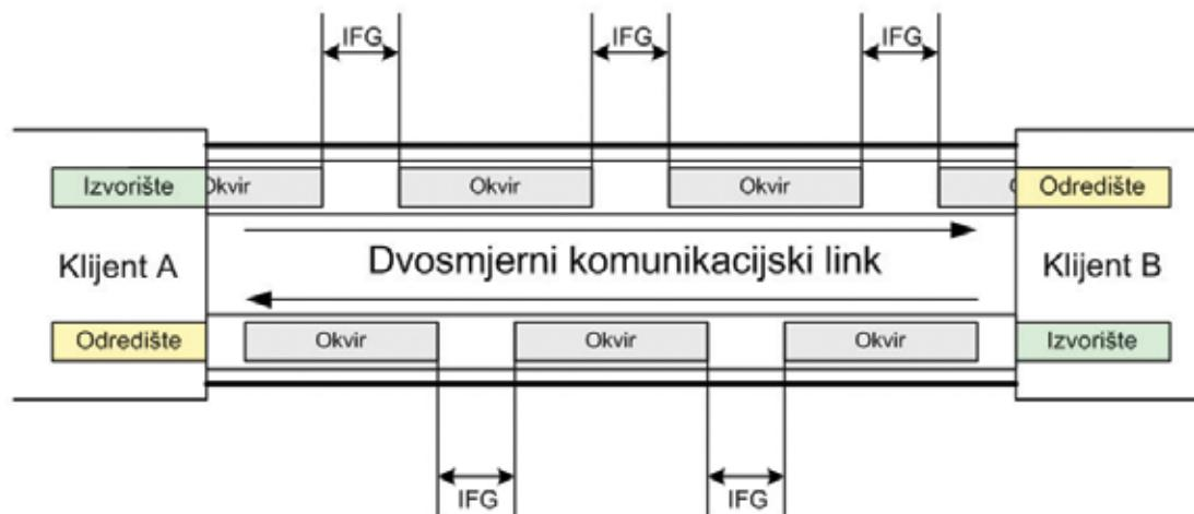
**Slika 3. Skica dvosmjernog (full-duplex) komunikacijskog linka u tehnologiji Ethernet**
