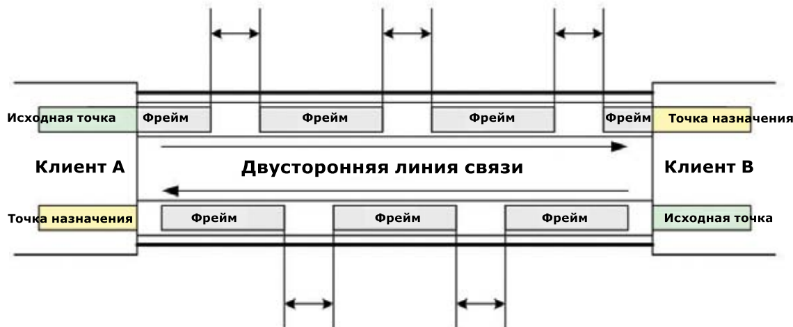
Рис. 3. Схема двусторонней (full-duplex) линии связи в технологии Ethernet
